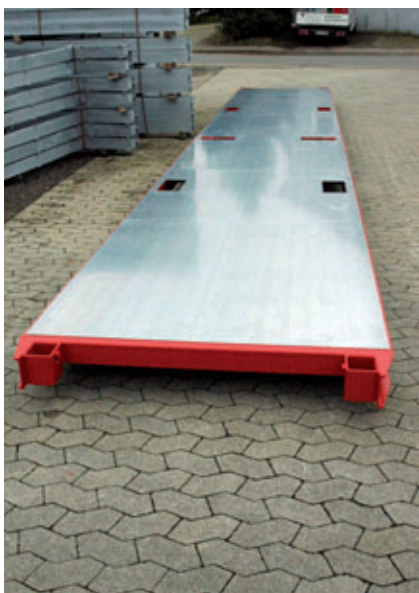
Die geschlossenen Profile sind weniger anfällig für Baustellendreck.
