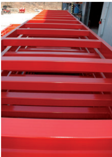
Die geschlossenen Profile sind weniger anfällig für Baustellendreck.
